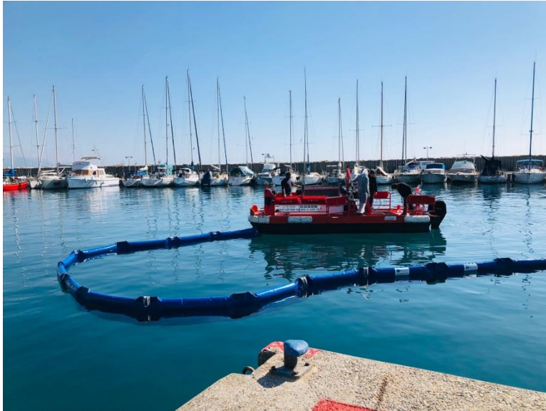
Déploiement d'un barrage de confinement
