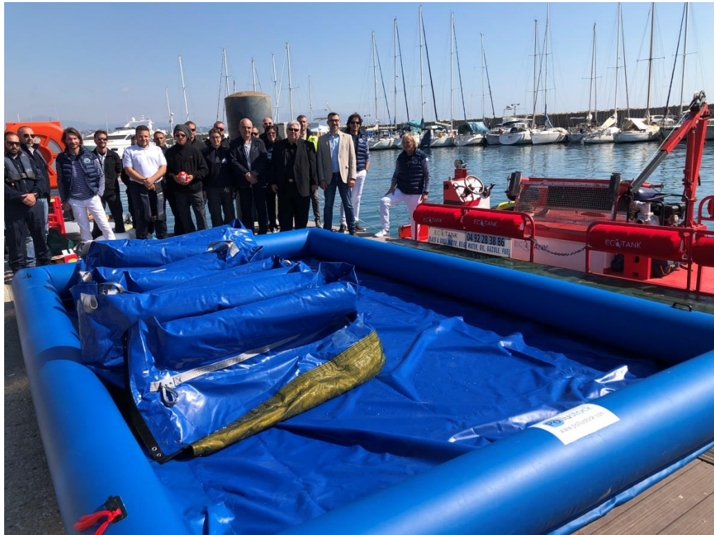
Piscine de dépollution et de décontamination avec barrage de confinement à jupe
